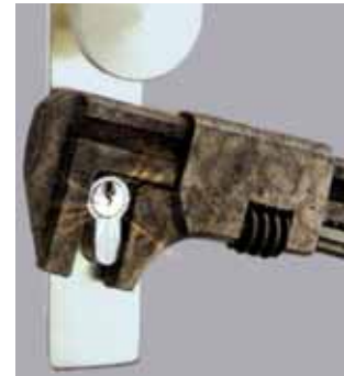
Bris d'un cylindre dépassant
